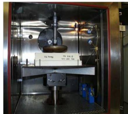
Рисунок 4: полиуретановая пена на основе метилендифенилдиизоцианата (MDI) в камере для испытания на динамическую усталость с насосами и фильтрами для отбора проб воздуха.
